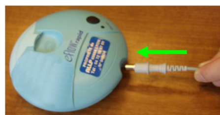
13 - Branchez la fiche ronde du câble du nébuliseur dans la prise avant du compresseur.
